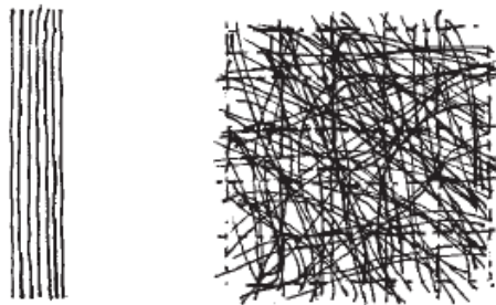
Figura 3-1. Fibra en roving(a) y mat de hilos cortados (b). Extraído de [2].
