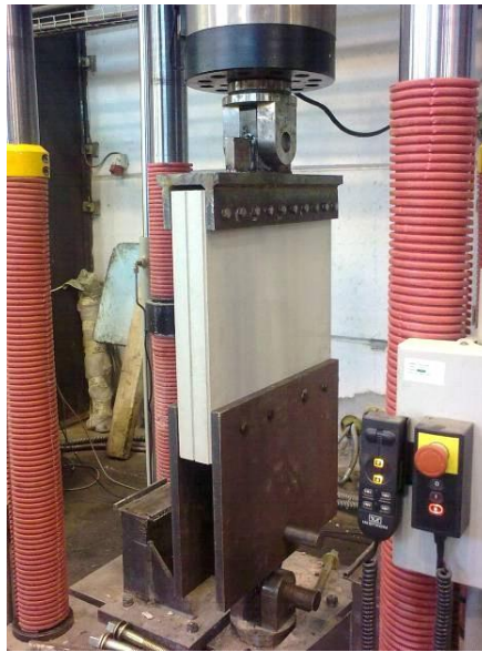
Figura 4-10. Disposición del ensayo de uniones mecánicas.
