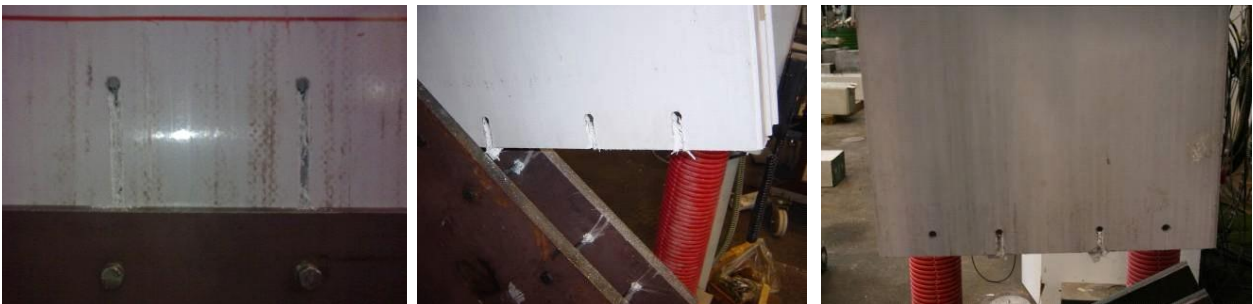
Figura 4-12. Imágenes de los fallos por desgarre del material en las probetas.
