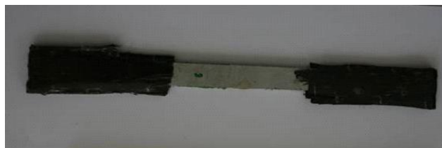
Figura 4-3. Probeta del ensayo de tracción longitudinal del laminado con las mordazas situadas en los extremos.
