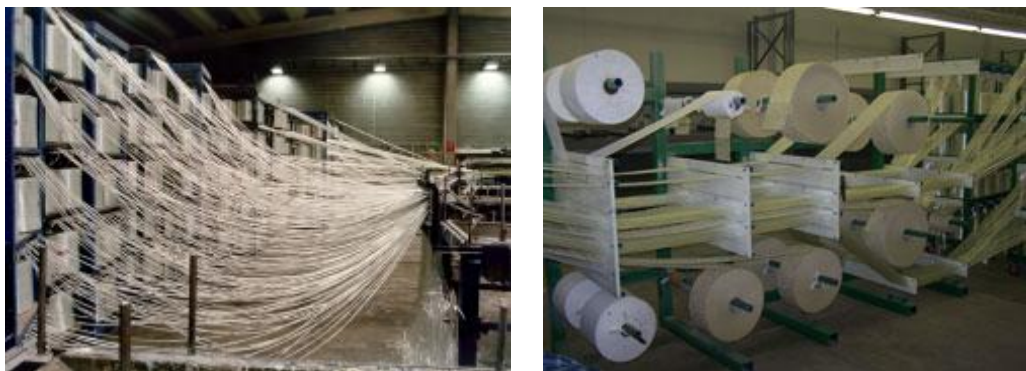
Figura 3-8. Parte inicial con las bobinas y cantres con mats de fibra de refuerzo.
