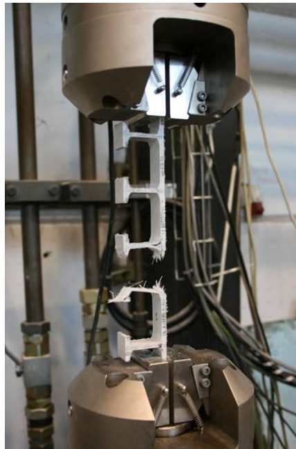
Figura 4-9. Delaminación interna de una probeta en el ensayo de tracción.
